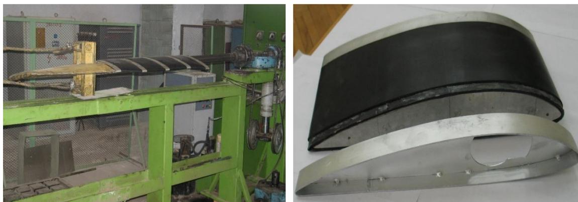
Рис. 3. Стенд для статических испытаний и лопасть с гибкими элементами и нервюрами
